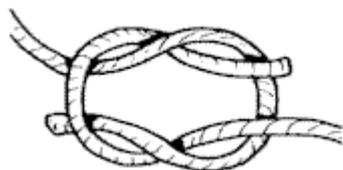
**Nodo incrociato o nodo della rete o nodo a bandiera:** Per unire due corde, anche di spessore differente, adatto anche per forti pesi. Per fabbricare una rete (da cui prende il nome). Nel caso di corde di spessore differente, è la corda più piccola che va incrociata perché la trazione la fa immobilizzare.
