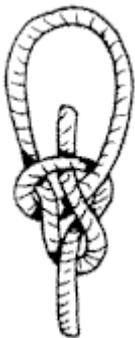
**Nodo di Carrick:** Carrick in irlandese significa roccia e questo nodo, molto solido, serve per unire corde di almeno 20 mm di diametro, sottoposte a sforzi considerevoli. Il nodo di Carrick va completato con due piccole legature a fasci.
